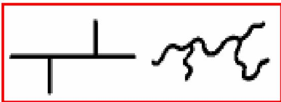
Нанесение покрытия и термообработка не сопровождаются химической реакцией. Таким образом, после охлаждения, при повторном термическом воздействии происходит повторное плавление термопластичных материалов.
